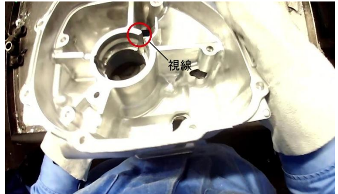
図5 鋳物のバリ取り作業と目視検査の例
